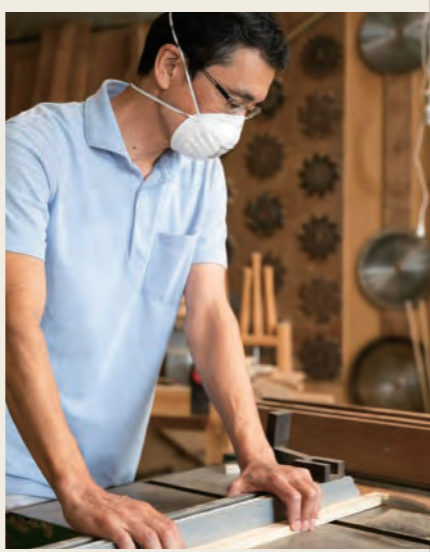
皮が付いた状態の木材を平らにして厚みや長さを決め、カットして部材にする。写真はその木取り作業。強度を出すために、どこをどう使うか慎重に行う。
